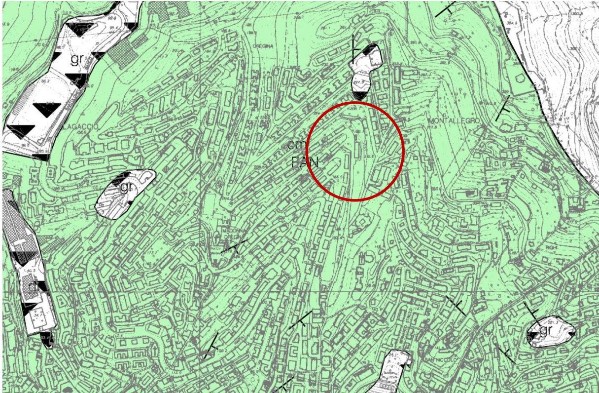
Carta Geolitologica del Piano di Bacino, Ambito 14. L'intera porzione è interessata dai calcari marnosi (cm) della Formazione del Monte Antola (FAN). Poco a monte è evidenziato uno sbancamento.
