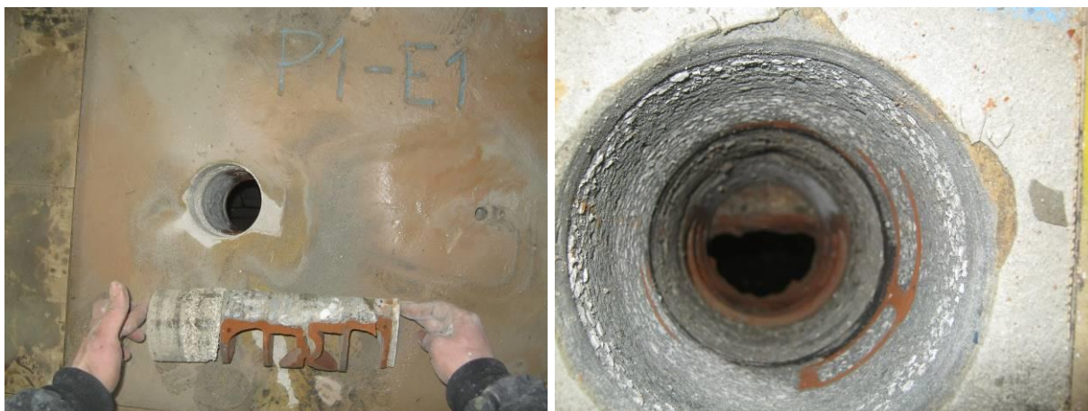
Figura 6. Carotaggi su solaio al piano 1° per valutazione spessori e stratigrafia
