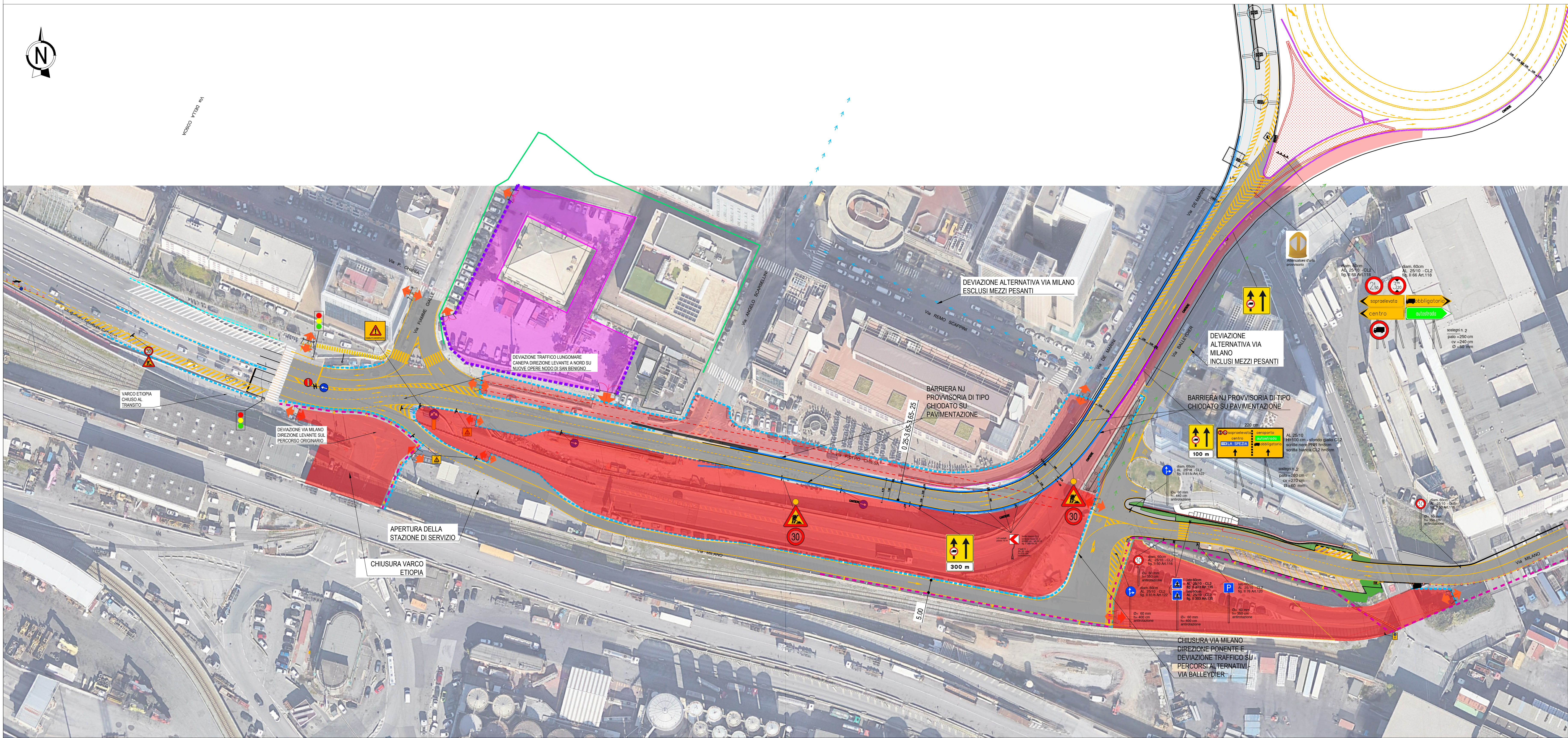
PLANIMETRIA CANTIERIZZAZIONE VIABILITA' LUNGOMARE CANEPA - VIA MILANO DIREZIONE LEVANTE scala 1:500
