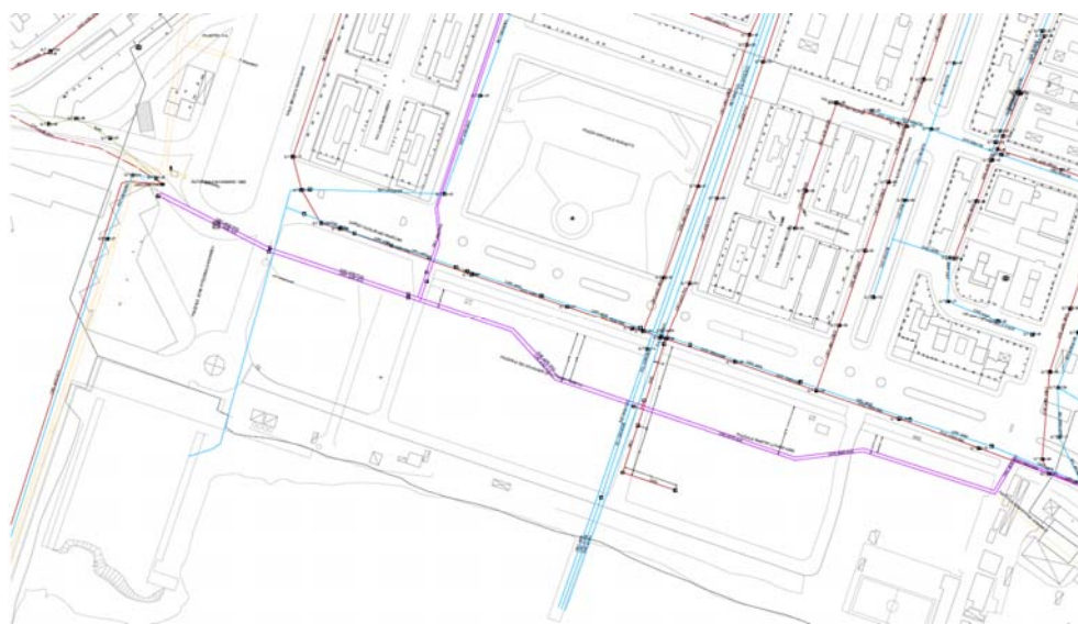
Figura 11 - Tracciato attuale delle linee fangodotto (in viola), delle reti bianche (in azzurro) e fognarie (in rosso) nell'area di Piazzale Kennedy
