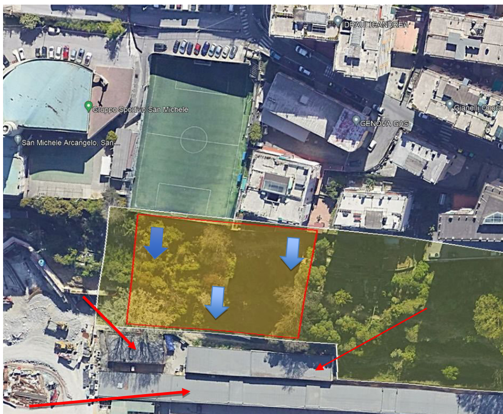
Figura 2: dettaglio dell'area. In rosso settore di scarpata oggetto della criticità. Le frecce a indicare la direzione dei deflussi ed i locali della Società che ha lamentato i diversi episodi di allagamento
