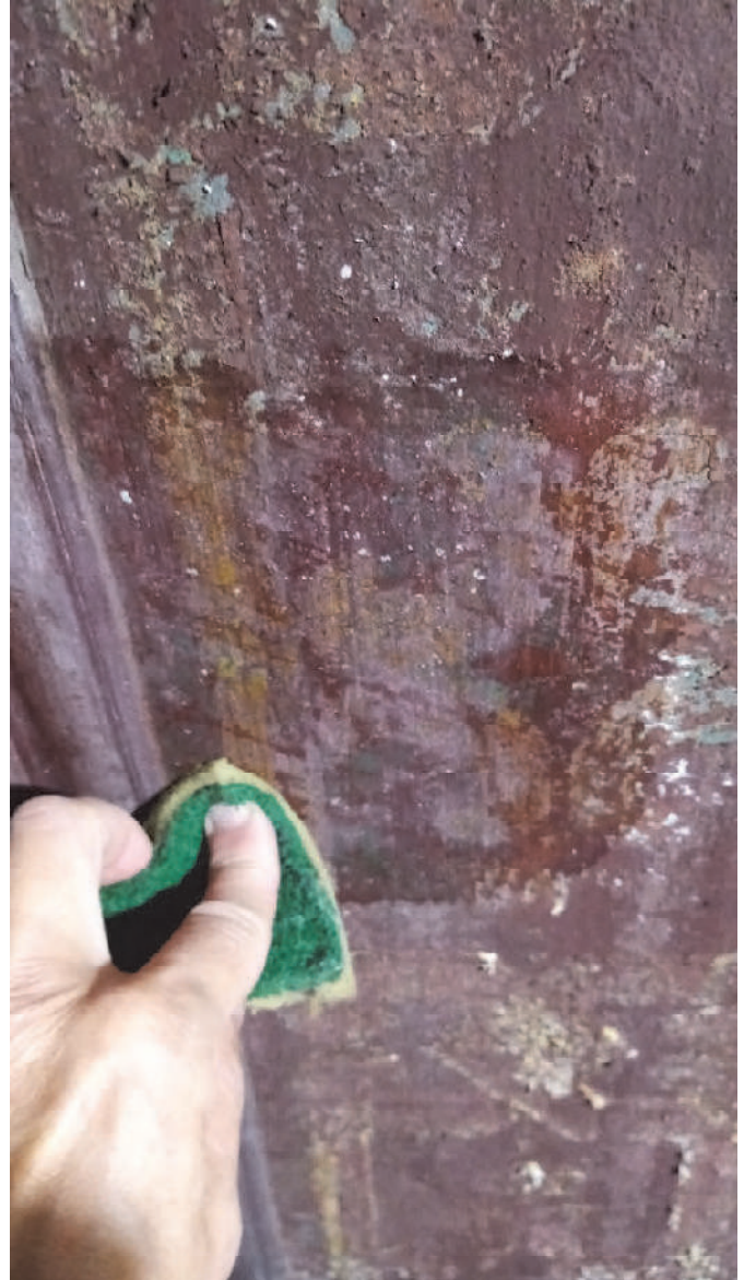
Img 11 - IMG_0913: tassello di pulitura; Img 12 - IMG_125146: prova pulitura con rimozione ridipintura
