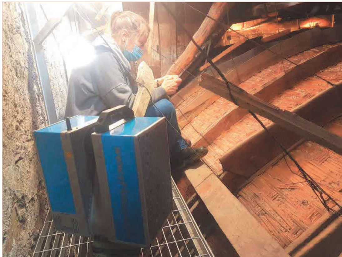
Acquisizione delle scansioni per il rilievo laserscanner.
