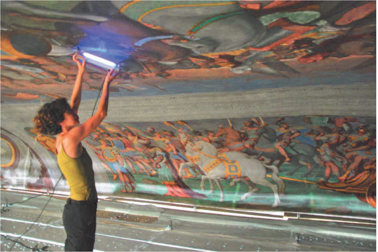
Img. 15– DSC_0709: utilizzo della lampada di Wood.
