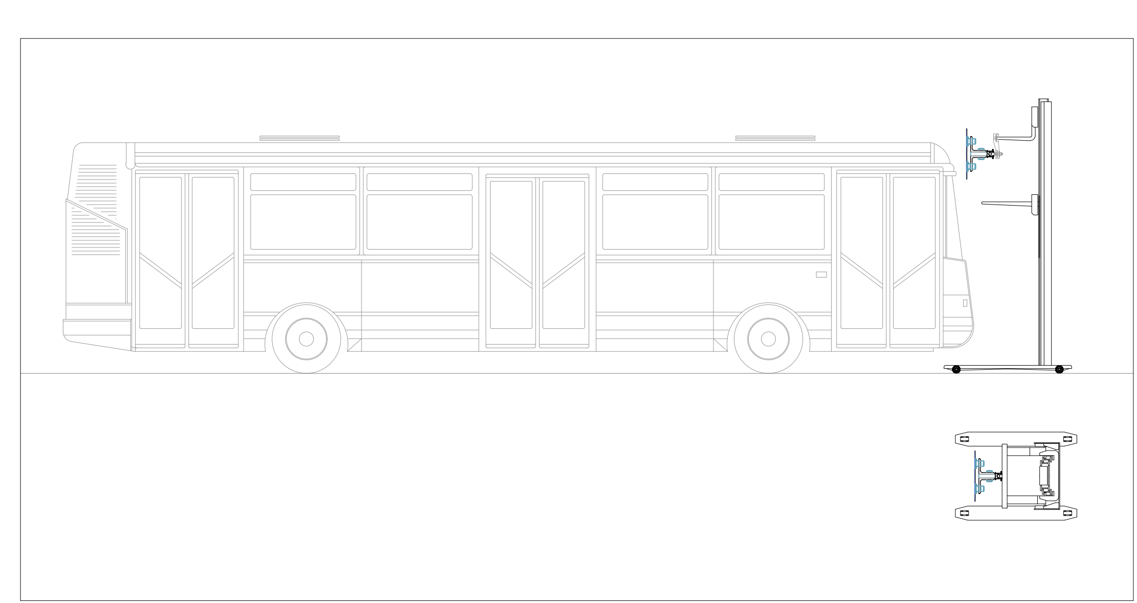
TIPOLOGICO CARRELLO SOLLEVATORE CON VENTOSE PER CRISTALLI
