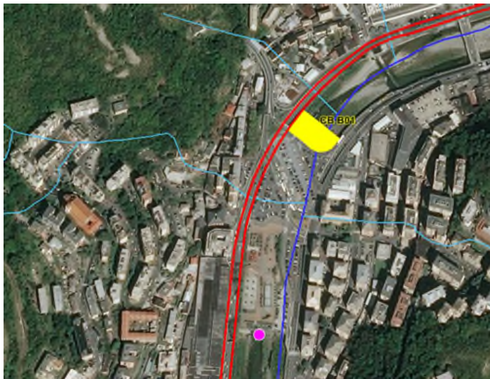
Figura 6-1: Ubicazione indicative dei punti di monitoraggio delle acque superficiali per il cantiere base B01
