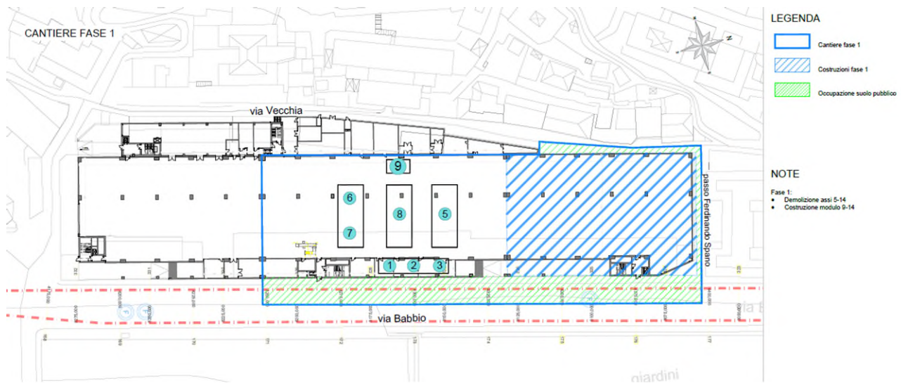
Figura 4-14: Layout del cantiere di Staglieno fase 1
