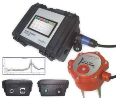
Figura 2. Indagini sismiche passiva HVSR. Tromino e sensore triassiale (set completo).
