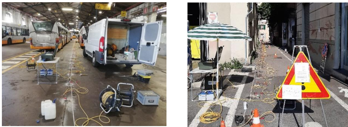
Figura 24. Foto indagini ERT deposito di "Staglieno".
