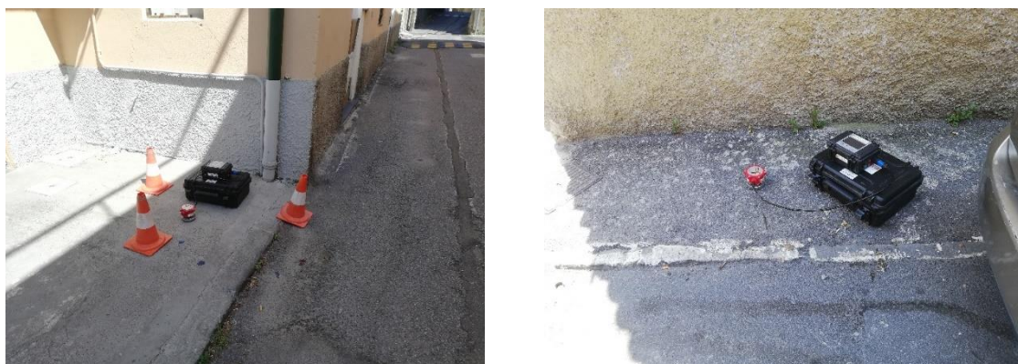
Figura 14. Foto indagini HVSR deposito di "Staglieno".
