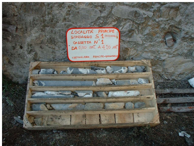
Figura n. 4 -Carotaggi nelle murature di sostegno tratto Principe - Bari
