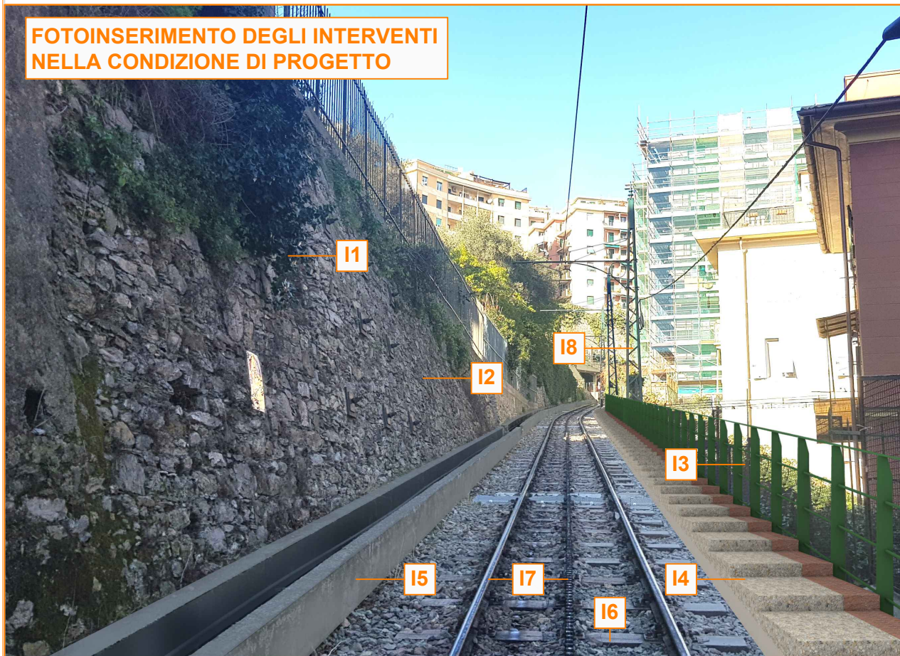
FOTOGRAFIA ESEMPLIFICATIVA DI UNA PORZIONE DI MURO IN PIETRE PER CUI E' RICHIESTO INTERVENTO DI CONSOLIDAMENTO
