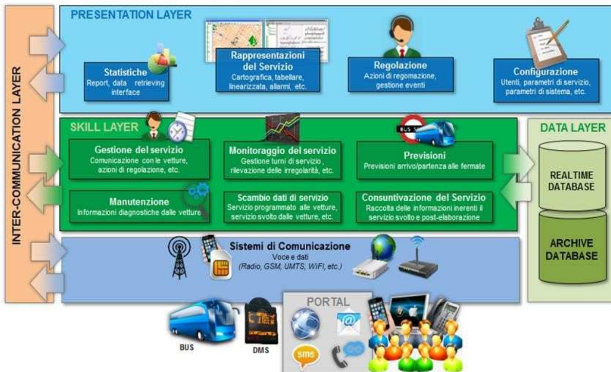
Figura 2 – Schema a blocchi funzionale del Sistema di Centrale AVM SIMON
