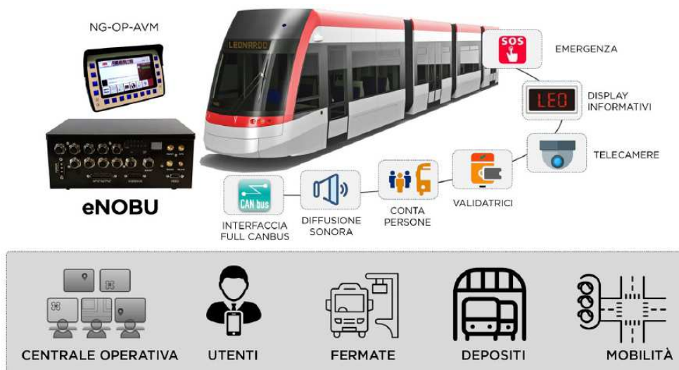
Figura 3 – Schematizzazione Architettura Apparati terra e bordo
