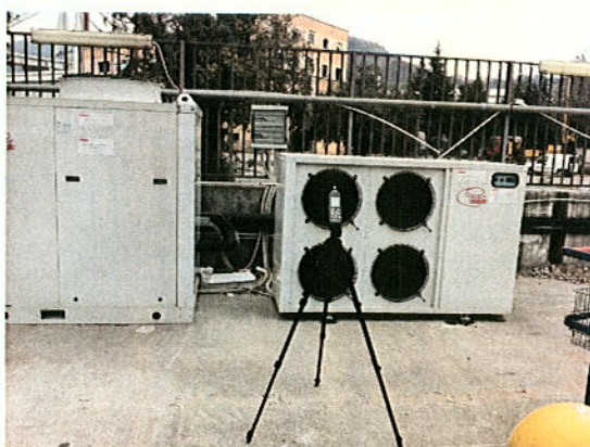
Figura 2 – Postazione di misura 2 (in esterno vicino ai condensatori )
